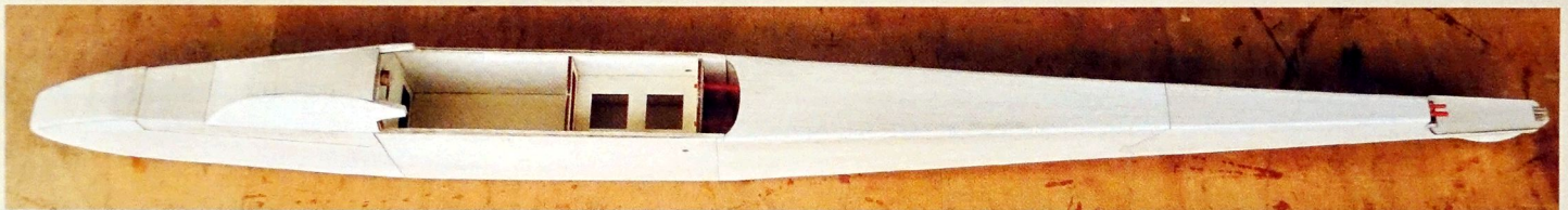
Der verschliffene, rohbaufertige Rumpf
