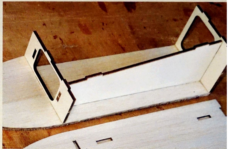
Beim Aufbau des Vorderrumpfs gehe ich genauso vor: Auf dem rechten Seitenteil habe ich beide Spanten und die Akkuträger-Platte geklebt, das linke Seitenteil auf die Einheit fixiert und festgeklebt
