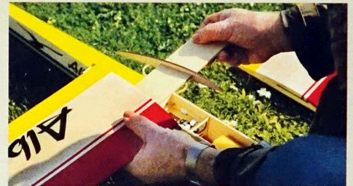
Die Flächensteckung ist ein flaches Brett
